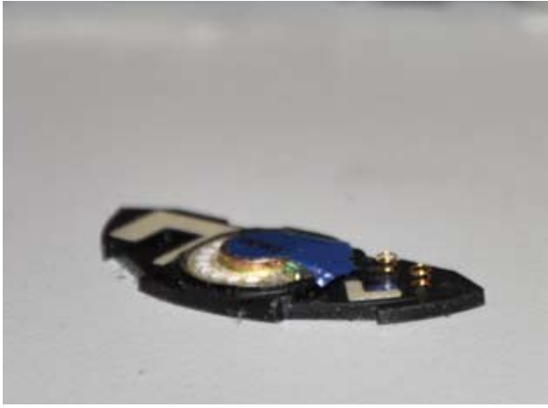
Links: Lautsprecher als Ausgangsform für RD_07. Größe: 3,9 \times 1,6 \times 0,3 cm. Rechts: CAD-Modell.
