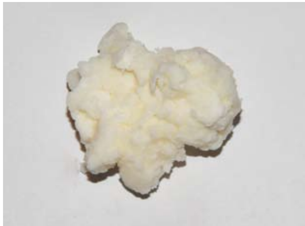
Verschiedene Ansichten der zugrundeliegenden Form von RD_06. Ganz oben rechts sieht man die blumenkohlartigen Strukturen, die durch das Tiefkühlen ermöglicht wurden. Größe der Formen ca. 4 \times 3 \times 2 cm.
